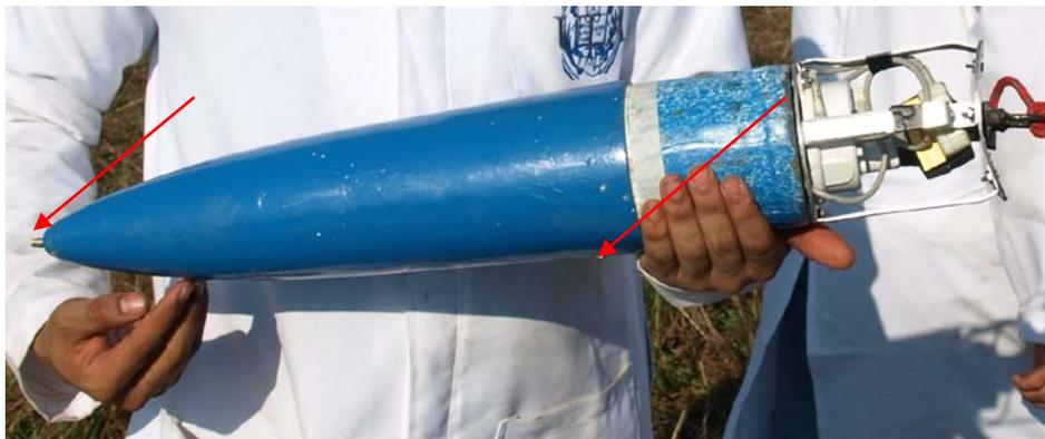
**Foto 3.** Nariz del cohete sonda ULA-1, junto a la carga útil (sensores meteorológicos) y termocuplas (flechas rojas) embutidas en la nariz ubicada en el morro y la otra, aguas abajo de la misma.
