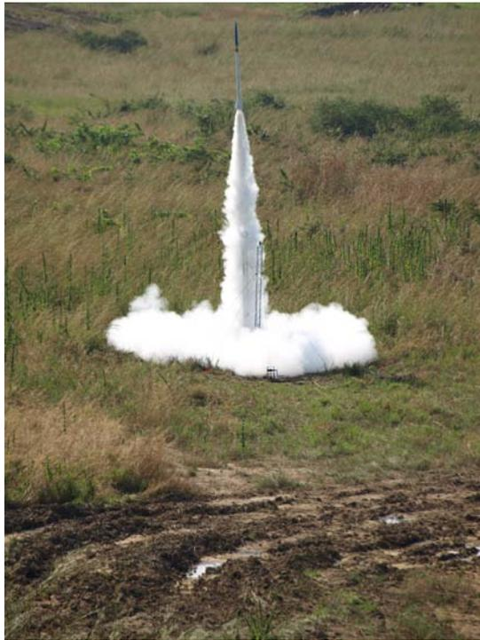
**Foto 6.** Despegue del cohete supersónico ULA-2 “Bicentenario” de la lanzadera de 4 metros de altura, durante la Cuarta Prueba de Rendimiento Aerodinámico y Propulsión realizada en El Pao, estado Cojedes, el 26 de noviembre del 2012.
